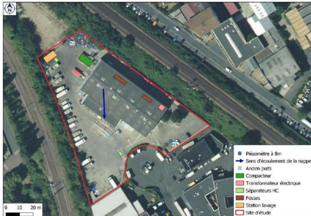
FIGURE 18 : PLAN DES INVESTIGATIONS SUR LES EAUX SOUTERRAINES
