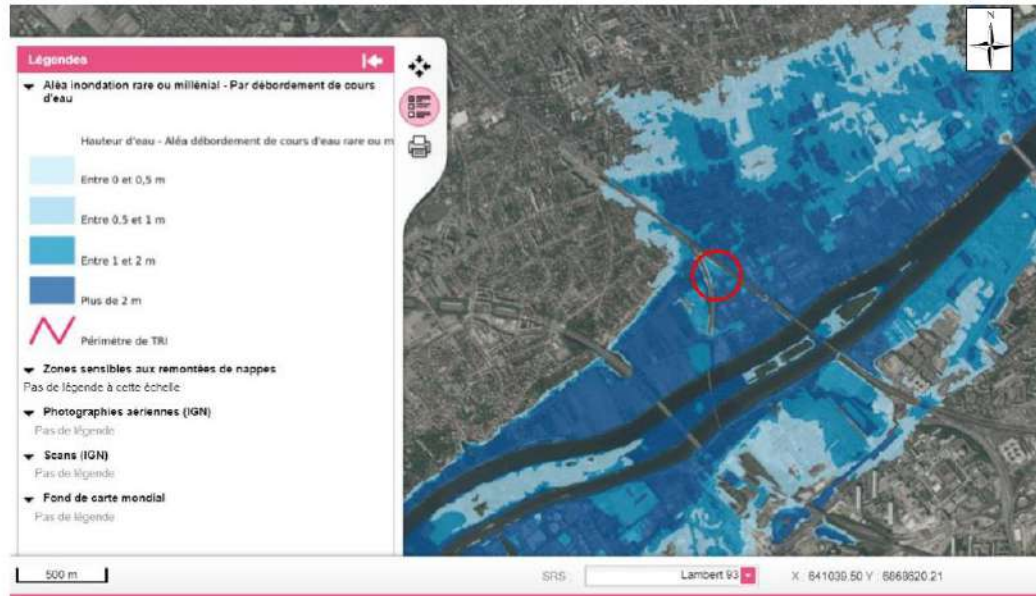
FIGURE 12 : IMPLANTATION DU SITE PAR RAPPORT AU RISQUE D'INONDATION (SOURCE : WWW.GEORISQUES.GOUV.FR )
